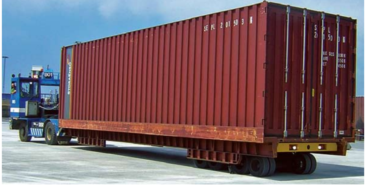
SECU under transport på plattan. Här står den placerad på en hydraulvagn, dragen av en terminaltraktor.
